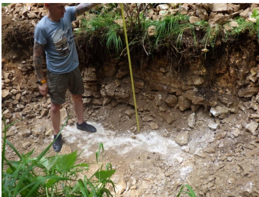
Foto 5.2. Kaevandiga K-8 avati maapinnast 1,2 m sügavusel Saunja kihistu (O3sn) lubjakivi (foto S. Siir, 29.06.2022, N 59°13'30,6"N ja 25°10'26,3"E).
